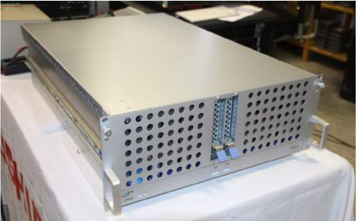
Imagen 1: El JBOD VTrak J5960 de PROMISE en el laboratorio Toshiba.
