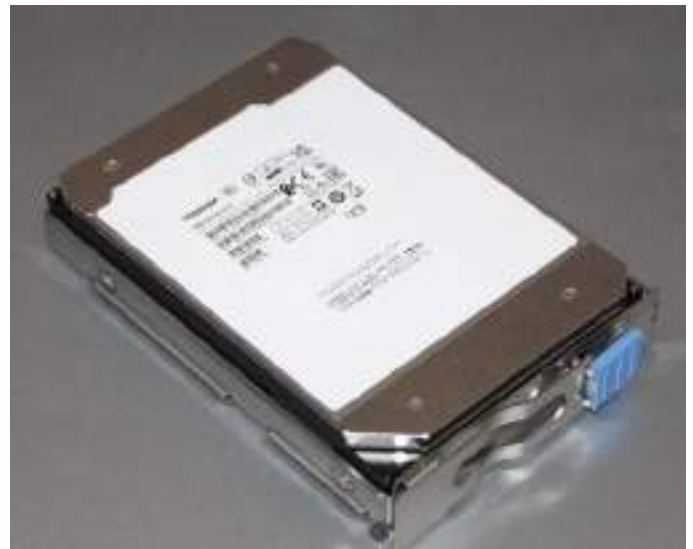
Imagen 3: Toshiba HDD MG09SCA18TE en bandeja PROMISE.
